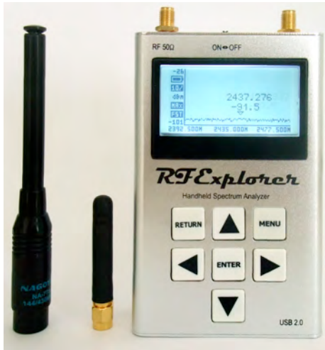
HF-Spektrumanalyse mit RF-Explorer
