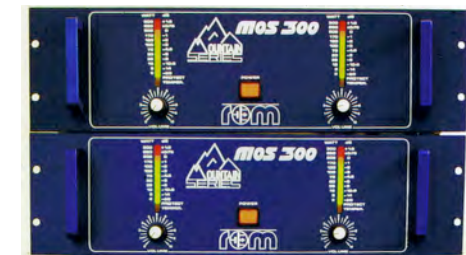
2x300 W MOSFET-Verstärker mit HiFi-Eigenschaften für die Disco und Bühne Baujahr ca. 1986
